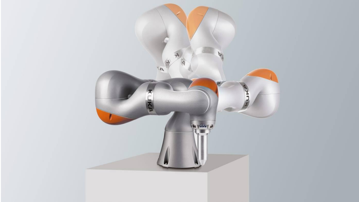
Figura 5 LBR iiwa produs de Kuka – cel mai sensibil robot din lume aprobat pentru lucru colaborativ om - robot. Foto: Kuka
