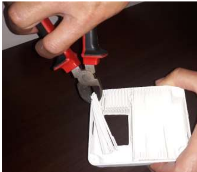
Înlăturarea structurii de suport. Sursa: Ludor Engineering
