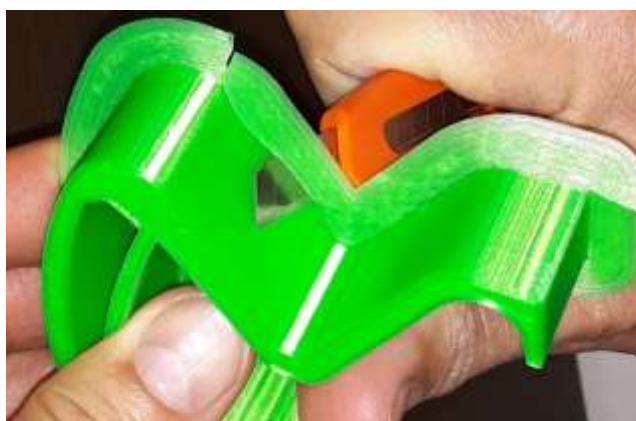
Îndepărtarea marginii. Sursa: Ludor Engineering
